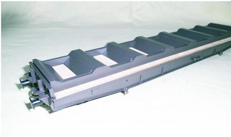
Der ausgelaserte Wagenboden in MDF mit Holz-Struktur wird angemessen und festgeklebt auf das Unterrahmen.
